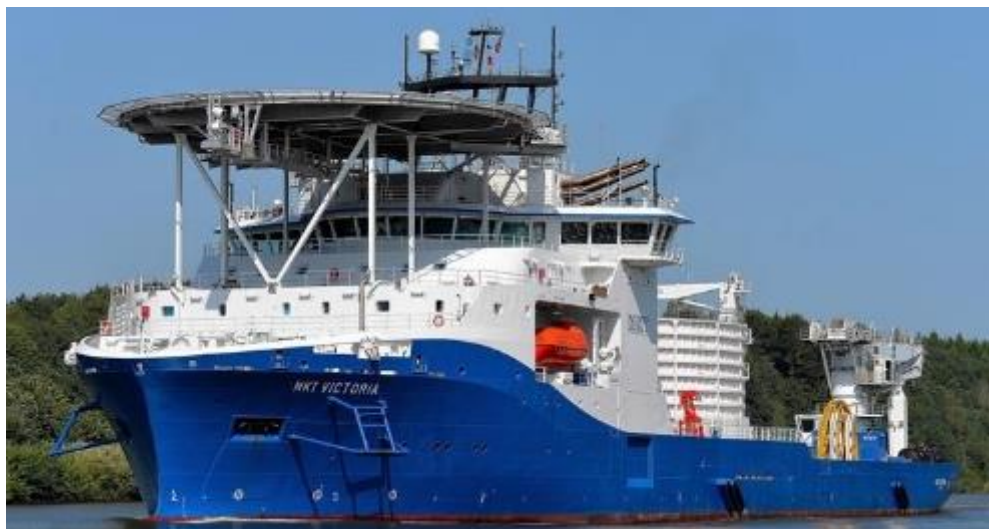
Fot. 2.1. Specjalistyczna jednostka do układania kabli podmorskich – kablowniec [Źródło: www.nkt.com ]
