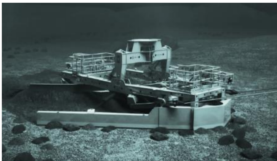
Fot. 2.2. Przykładowy pług służący do oczyszczania dna z głazów [Źródło: https://globaloffshore.co.uk/vessels-trenching-assets/pre-lay-plough/ ]
