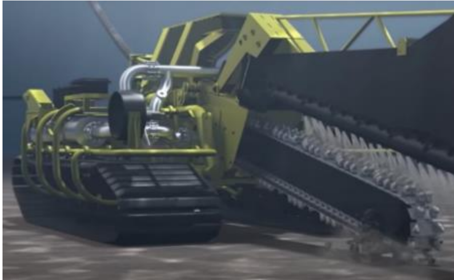
Fot. 2.5. Przykładowe urządzenie do mechanicznego zagłębienia kabli [Źródło: www.boskalis.com ]
