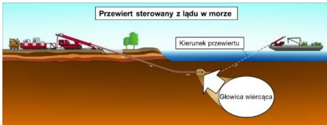
Rysunek 2.6. Przewiert metodą HDD ląd–morze [Źródło: https://www.hadleeandbrunton.co.nz/what-is-horizontal-directional-drilling/ ]
