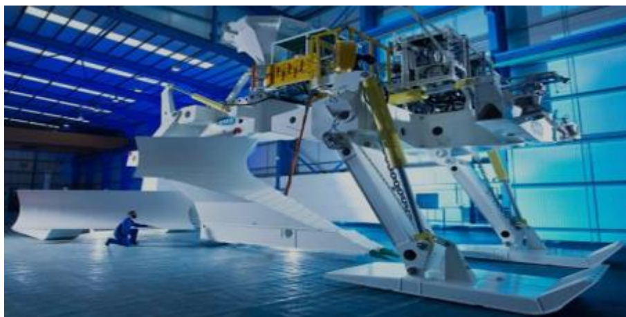
Fot. 2.6. Przykładowy pług kablowy [Źródło: https://www.youtube.com/watch?v=wblle4zRA2M ]
