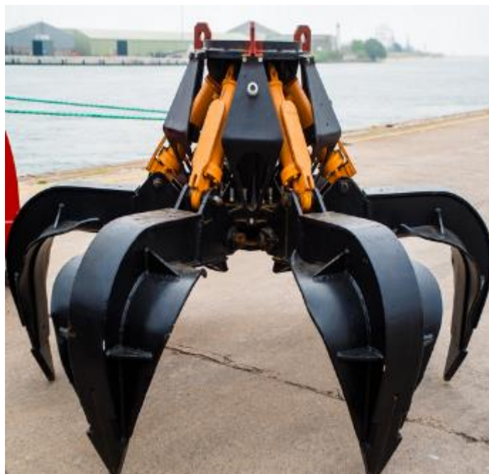
Fot. 2.3. Przykładowy chwytak do przenoszenia głazów w obrębie dna morskiego [Źródło: www.utrov.com ]
