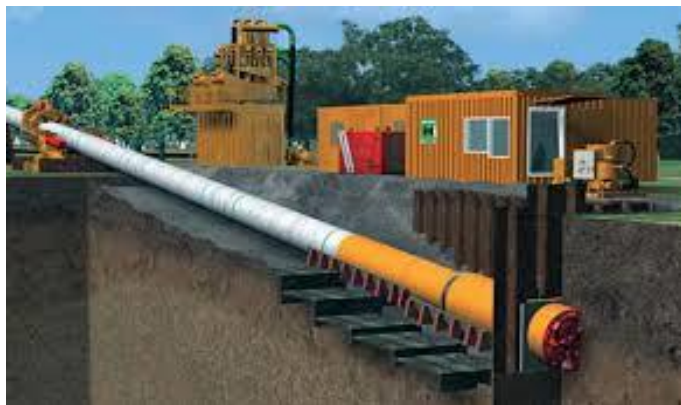
Rysunek 2.8. Widok technologii Direct Pipe [Źródło: http://www.indstt.com/pdf/HK_DirectPipe.pdf ]
