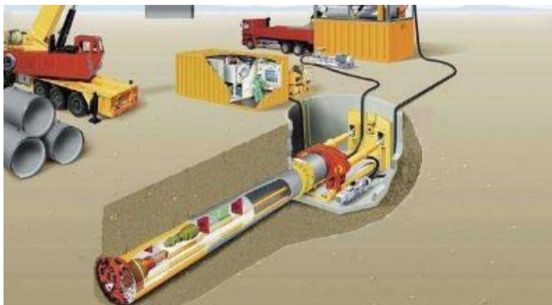
Rysunek 2.7. Schemat technologii mikrotunelowania [Źródło: https://inzynieria.com/inzbezwykopowa/artykuly/18061,abc-mikrotunelingu ]
