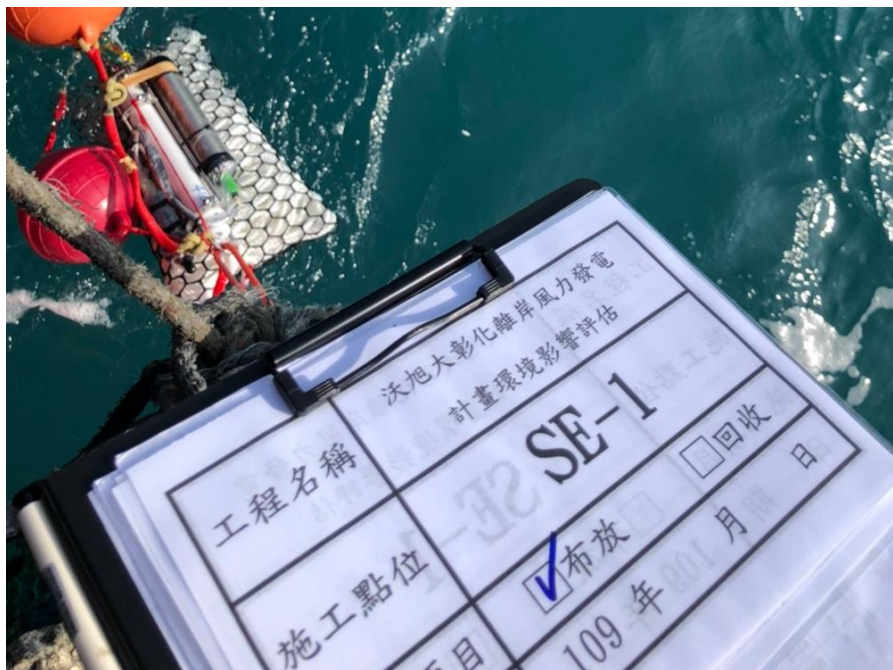
本季水下噪音儀器 SE-1 現場佈放
