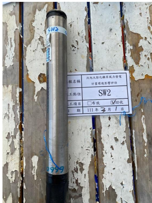
圖 2.6-4 水下噪音儀器 SW-2 現場回收
