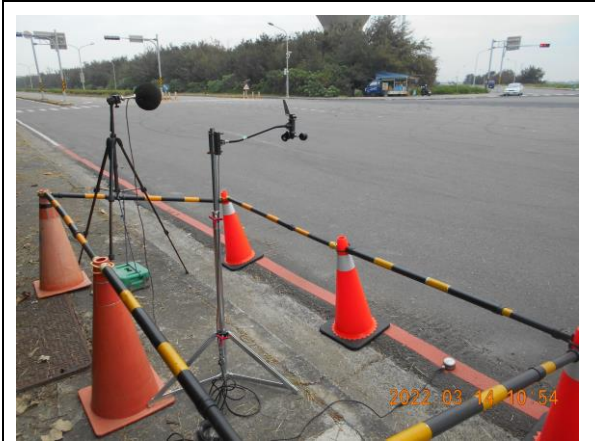
噪音振動：陸域工程進/出道路(111.03.14~15)
