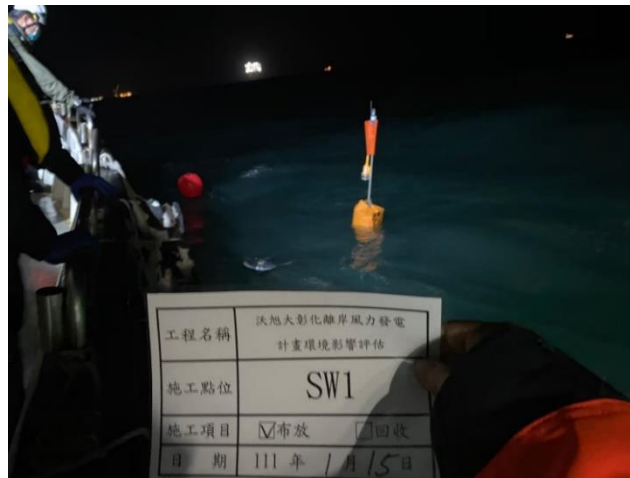
圖 2.6-1 水下噪音儀器 SW-1 現場佈放
