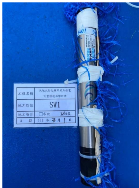
圖 2.6-2 水下噪音儀器 SW-1 現場回收
