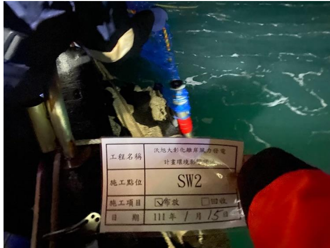
圖 2.6-3 水下噪音儀器 SW-2 現場佈放
