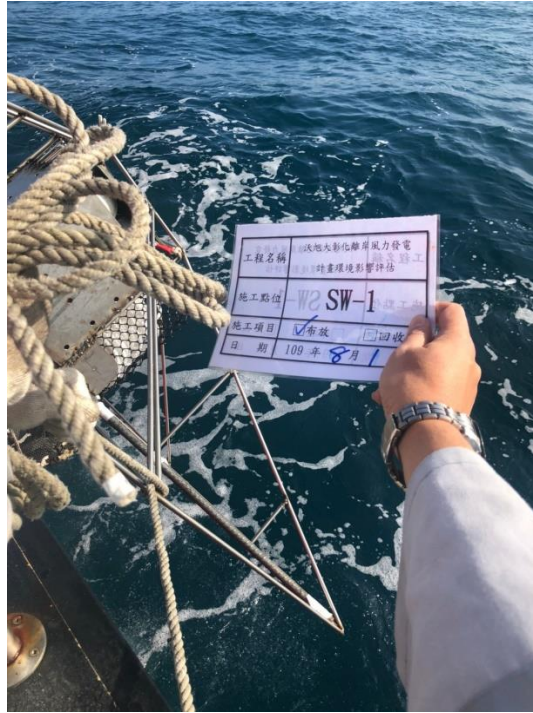
圖 2.5-1 水下噪音儀器 SW-1 現場佈放
