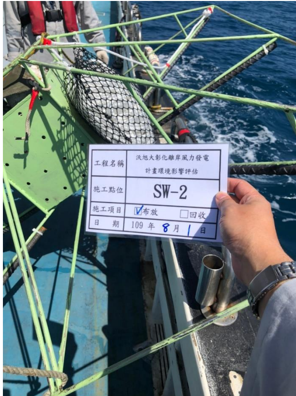
圖 2.5-3 水下噪音儀器 SW-2 現場佈放
