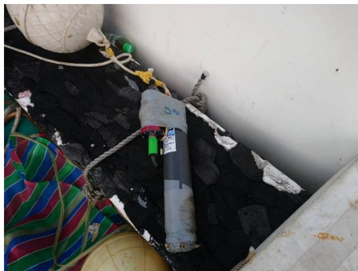
圖 2.5-2 水下噪音儀器 SW-1 現場回收
