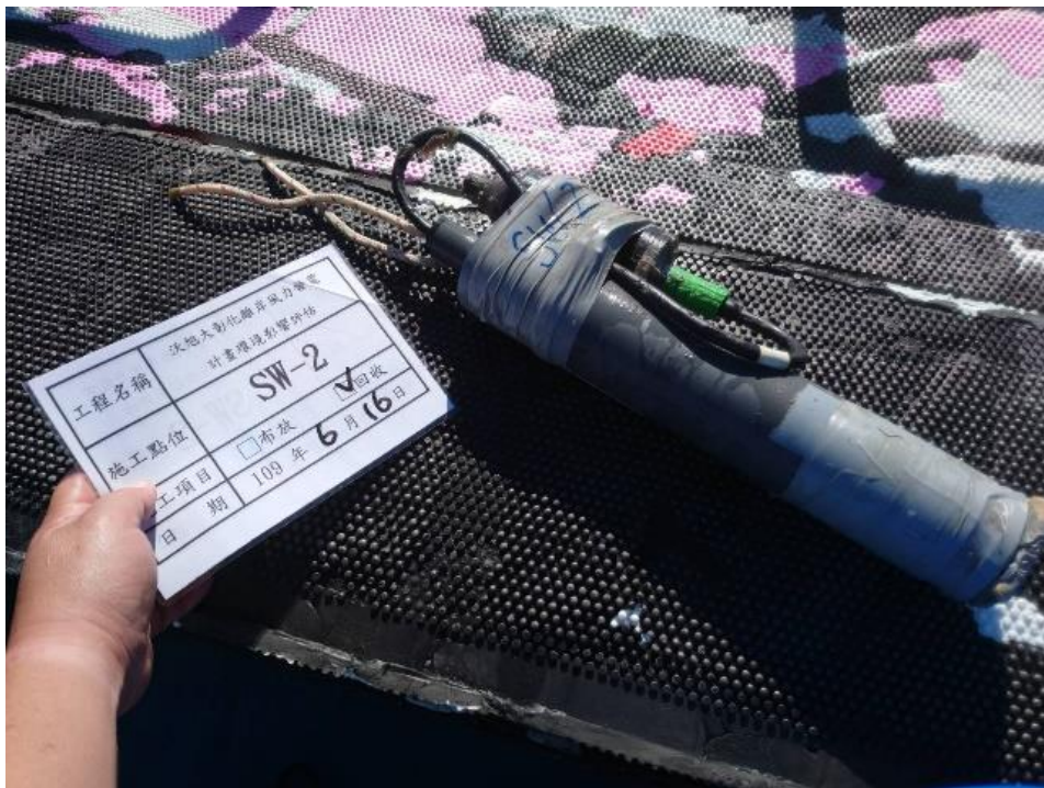
圖 2.5-4 水下噪音儀器 SW-2 現場回收
