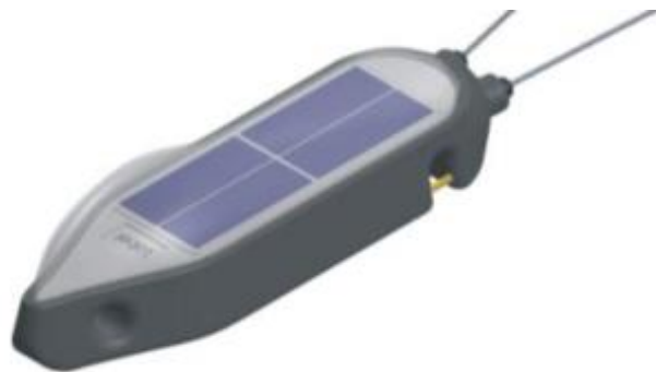
圖 2.3-2 PinPoint Argos Solar 衛星發報器(6 克)
