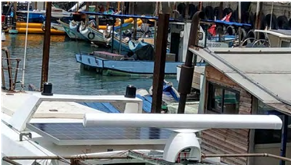
圖 1.4-4 架設於船舶上之雷達天線
