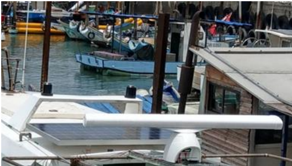
圖 1.4-4 架設於船舶上之雷達天線
