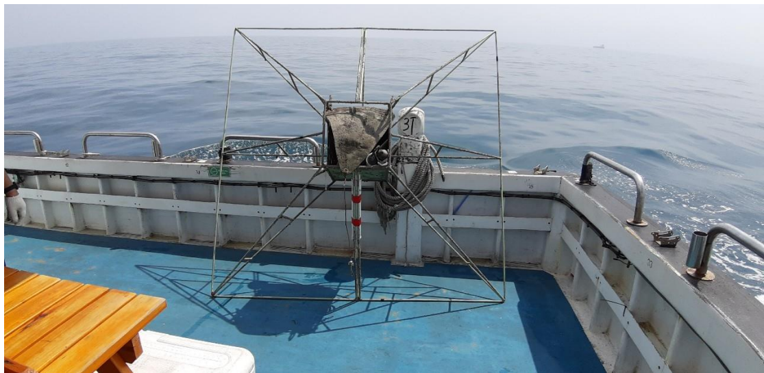
圖 2.5-2 水下噪音儀器 SE-1 現場回收
