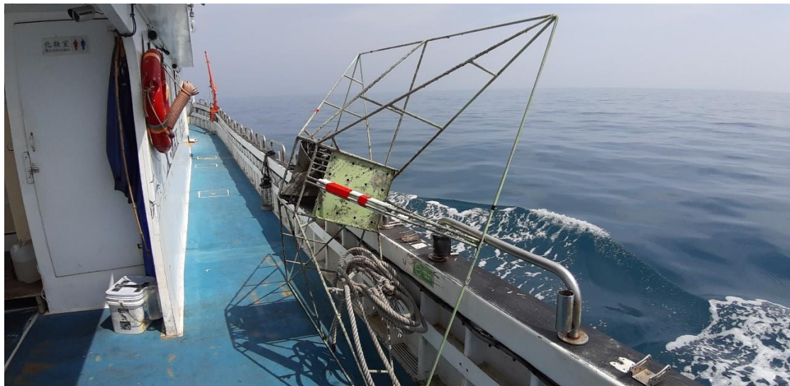
圖 2.5-4 水下噪音儀器 SE-2 現場回收
