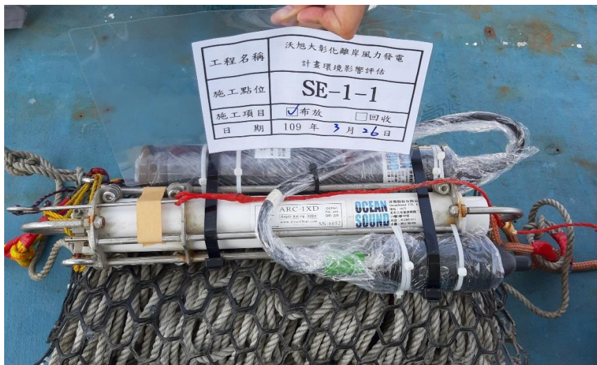
圖 2.5-6 水下噪音儀器 SE-1-1 現場補佈放
