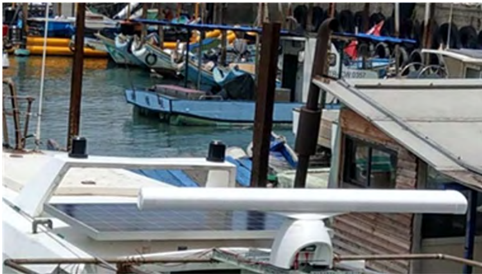
圖 1.4-4 架設於船舶上之雷達天線
