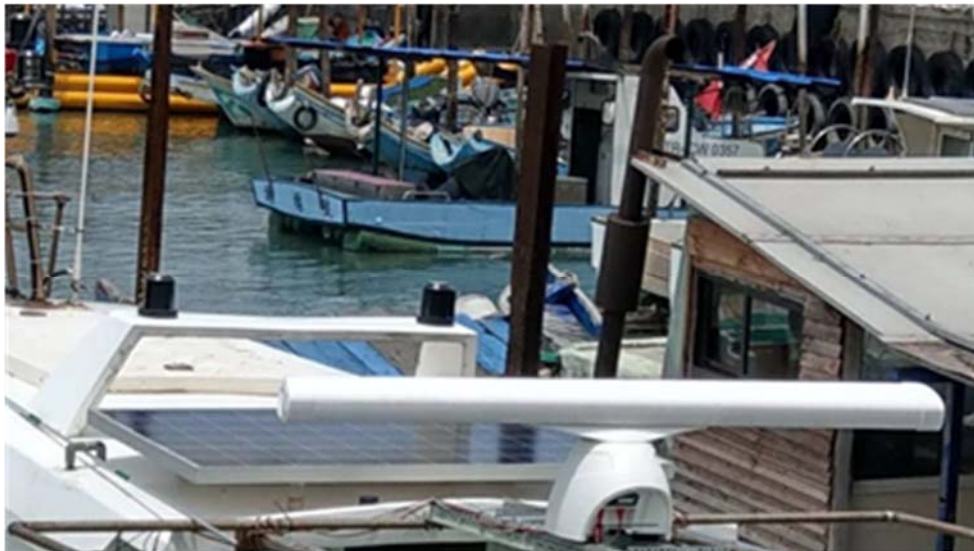
圖 1.4-4 架設於船舶上之雷達天線
