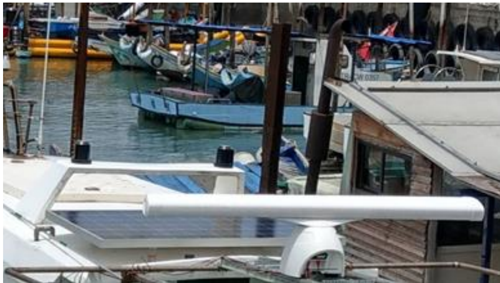
圖 1.4-4 架設於船舶上之雷達天線
