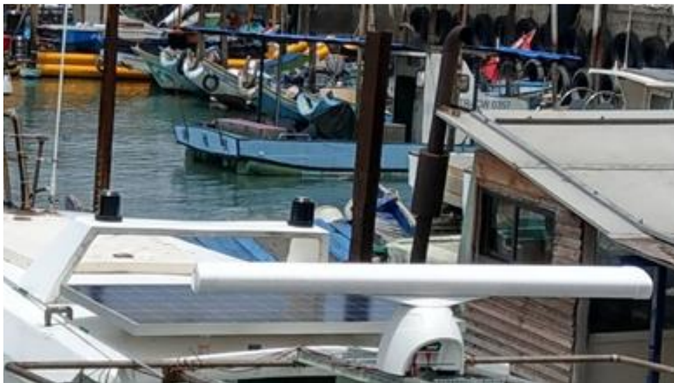
圖 4 架設於船舶上之雷達天線
