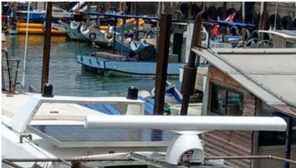
圖 1.4-4 架設於船舶上之雷達天線
