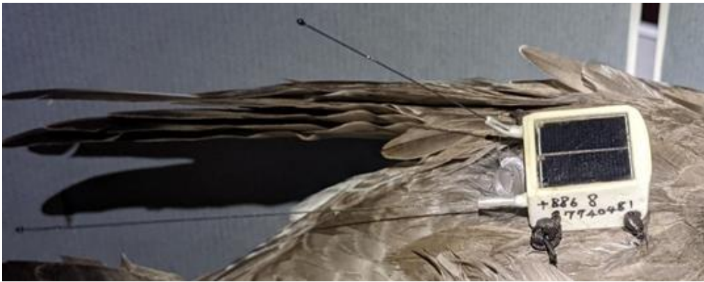
圖 1.4-6 Debut Mini 衛星發報器 (Druid, Inc.)
