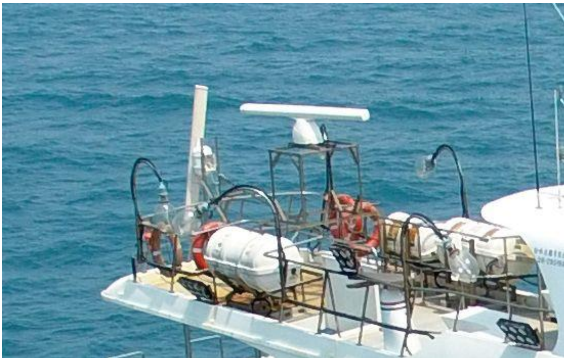
圖 1.4-4 架設於船舶上之雷達天線
