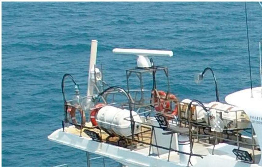
圖 1、架設於船舶上之雷達天線
