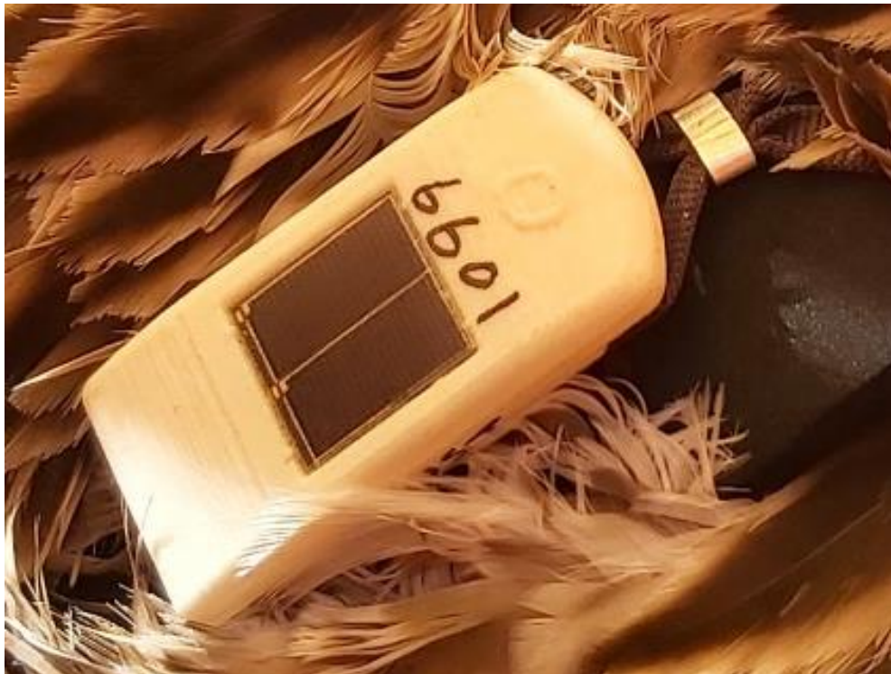
圖 1.4-7 Debut Flex 衛星發報器 (Druid, Inc.)
