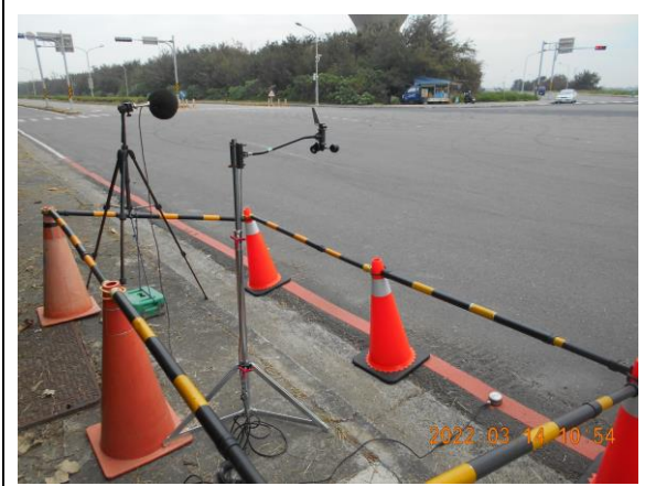
噪音振動：陸域工程進/出道路(111.03.14~15)
