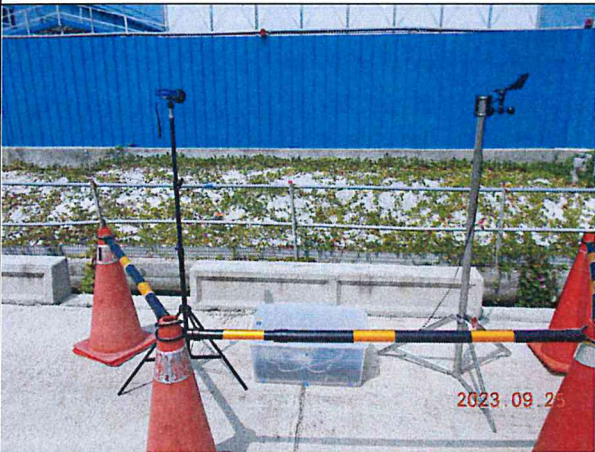
營建噪音：陸域自設升(降)壓站工地周界(112.09.25)
