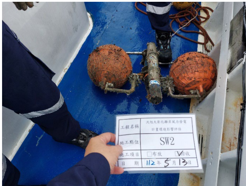
圖 2.6-4 水下噪音儀器 SW-2 現場回收
