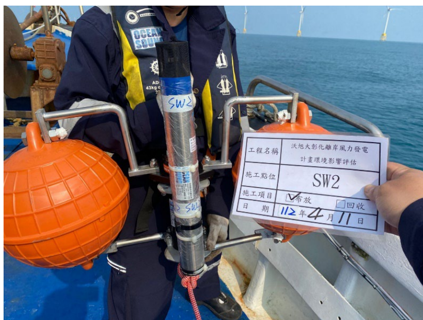
圖 2.6-2 水下噪音儀器 SW-2 現場佈放
