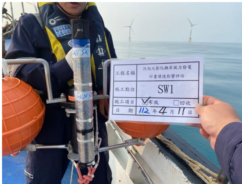
圖 2.6-1 水下噪音儀器 SW-1 現場佈放
