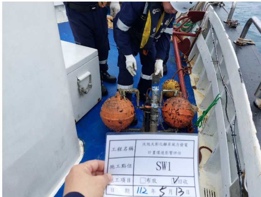
圖 2.6-3 水下噪音儀器 SW-1 現場回收
