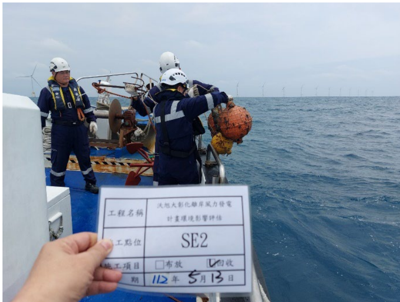
圖 2.6-4 水下噪音儀器 SE-2 現場回收
