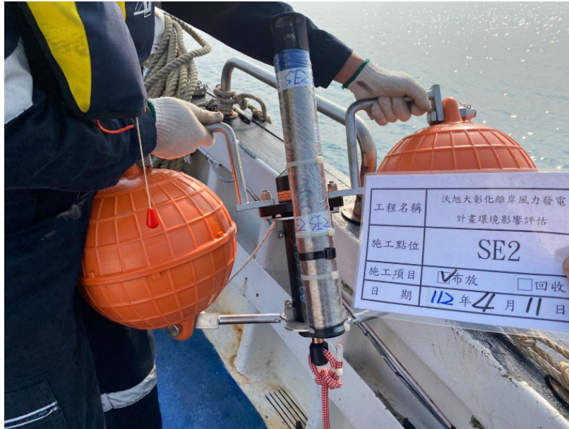
圖 2.6-3 水下噪音儀器 SE-2 現場佈放
