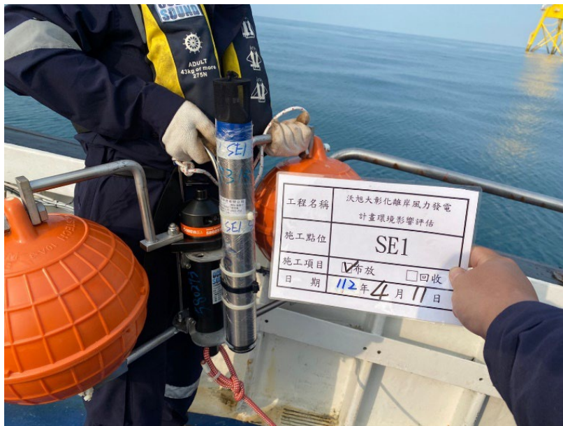
圖 2.6-1 水下噪音儀器 SE-1 現場佈放
