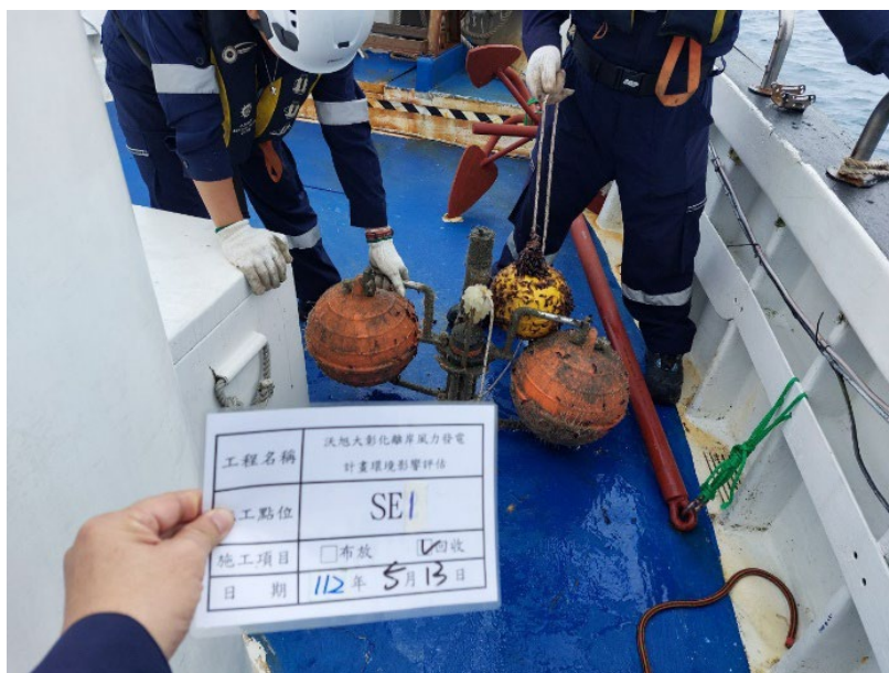
圖 2.6-2 水下噪音儀器 SE-1 現場回收
