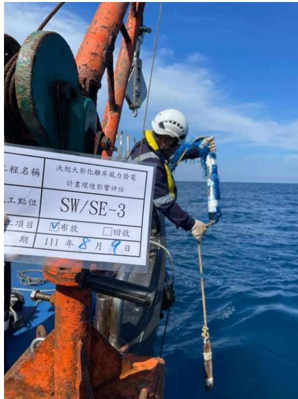
圖 2.6-5 水下噪音儀器 SW-3 現場佈放
