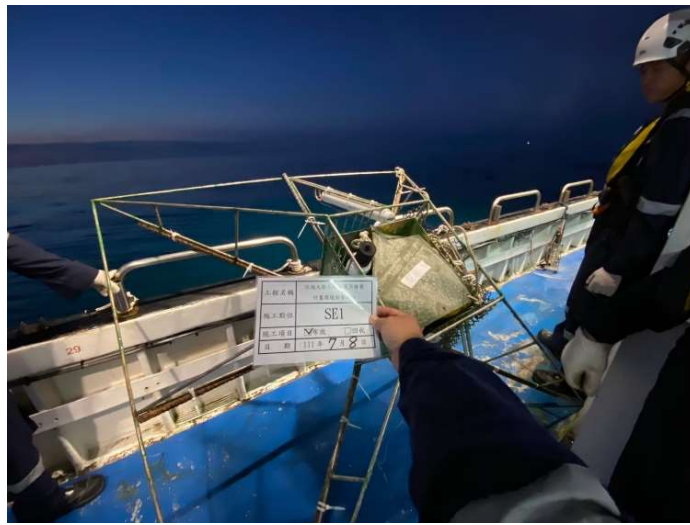
圖 2.6-1 水下噪音儀器 SE-1 現場佈放
