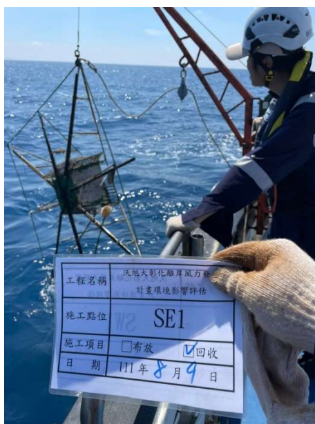
圖 2.6-2 水下噪音儀器 SE-1 現場回收
