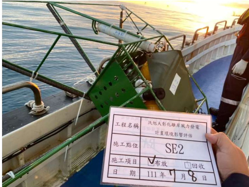
圖 2.6-3 水下噪音儀器 SE-2 現場佈放
