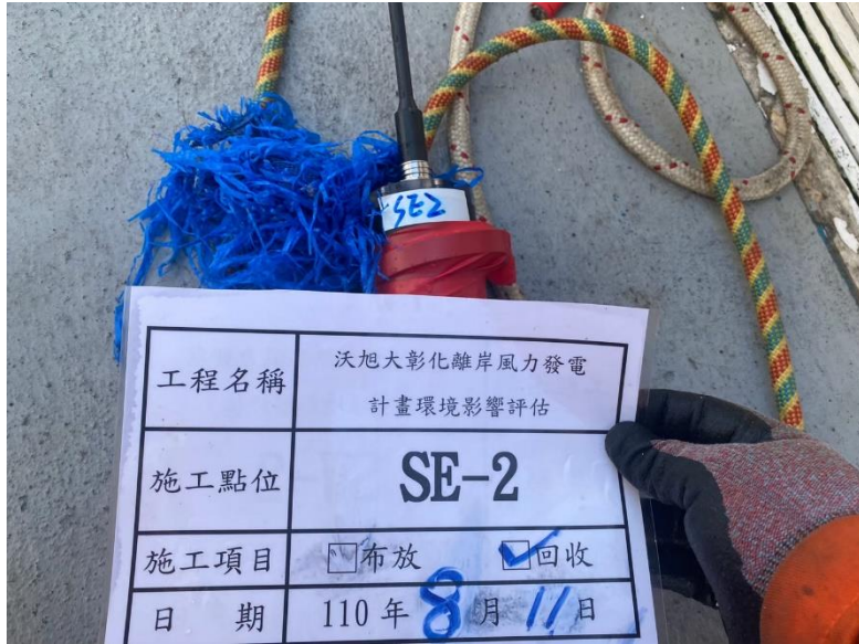
圖 2.6-4 水下噪音儀器 SE-2 現場回收
