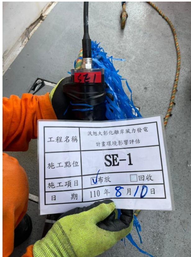
圖 2.6-1 水下噪音儀器 SE-1 現場佈放
