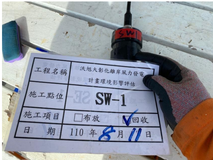
圖 2.6-2 水下噪音儀器 SW-1 現場回收
