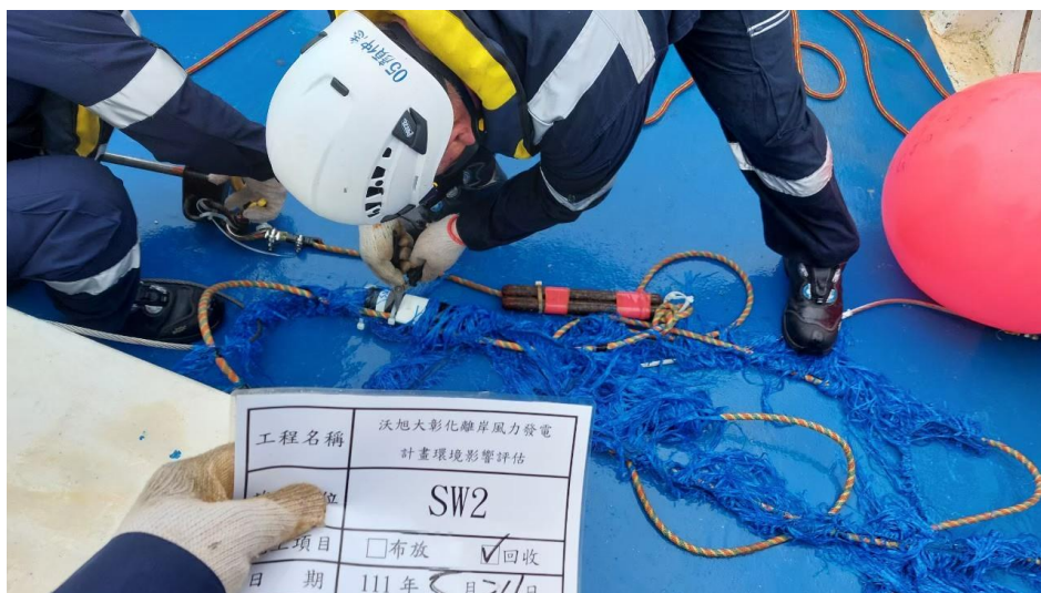
圖 2.6-4 水下噪音儀器 SW-2 現場回收
