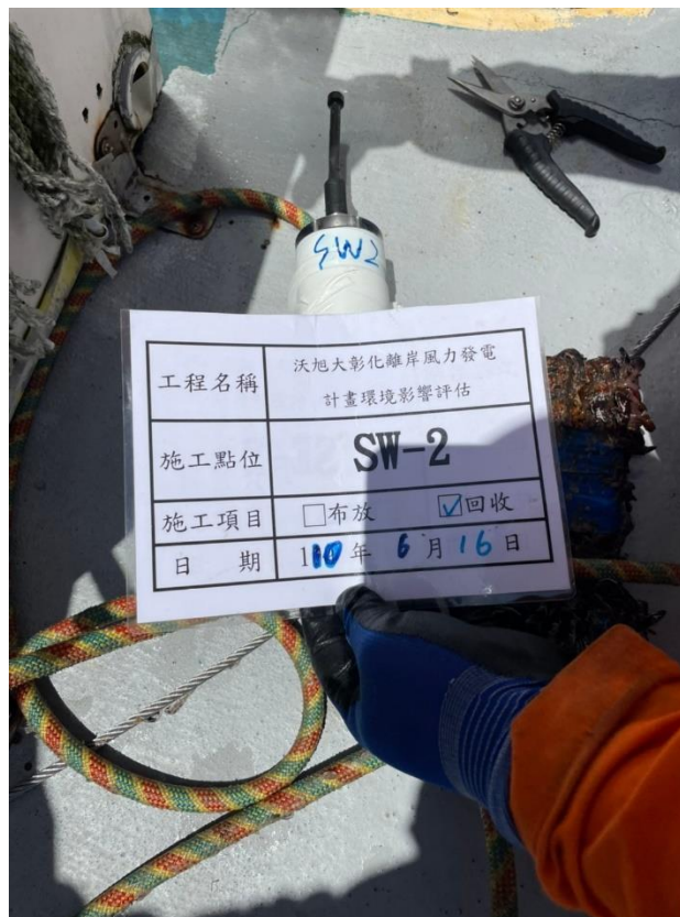
圖 2.6-3 水下噪音儀器 SW-2 現場回收
