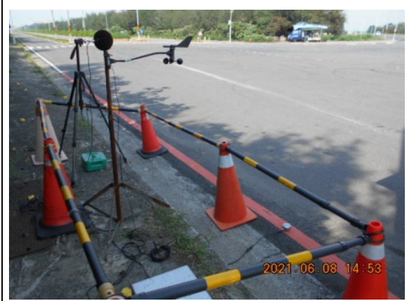
噪音振動：陸域工程進/出道路(110.06.08-09)
