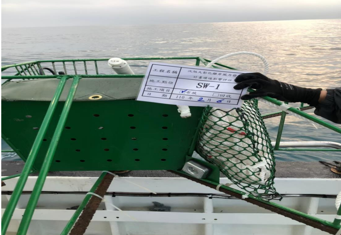
圖 2.6-1 水下噪音儀器 SW-1 現場佈放
