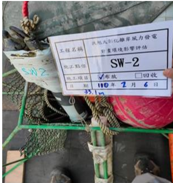
圖 2.6-2 水下噪音儀器 SW-2 現場佈放
