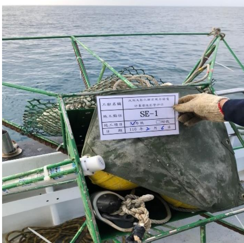
圖 2.6-1 水下噪音儀器 SE-1 現場佈放
