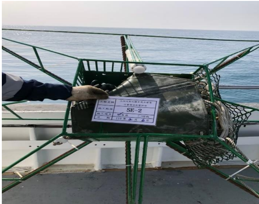
圖 2.6-3 水下噪音儀器 SE-2 現場佈放
