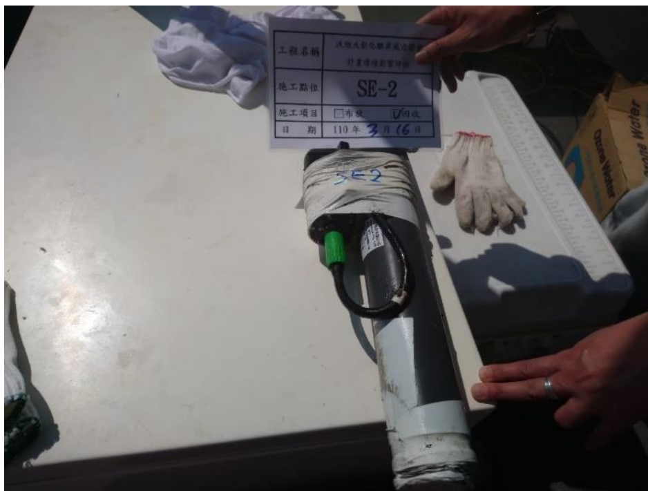
圖 2.6-4 水下噪音儀器 SE-2 現場回收
