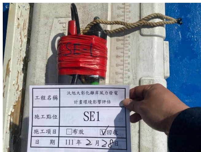
圖 2.6-2 水下噪音儀器 SE-1 現場回收
