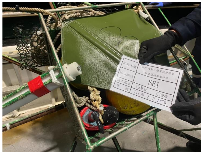
圖 2.6-1 水下噪音儀器 SE-1 現場佈放
