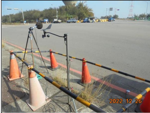
噪音振動：陸域工程進/出道路(111.12.26~27)
