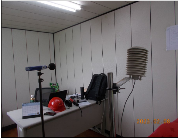
營建低頻噪音：陸域自設升(降)壓站工地周界(112.02.08)
