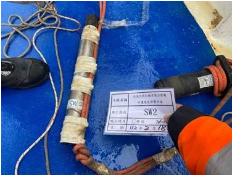
圖 2.6-4 水下噪音儀器 SW-2 現場回收
