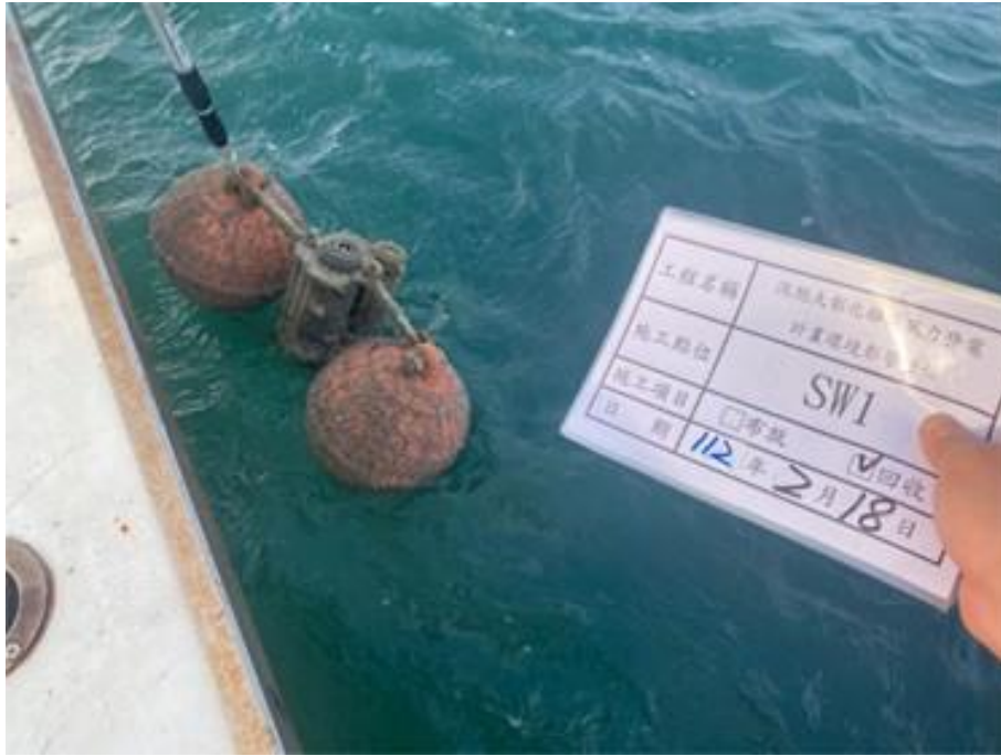
圖 2.6-3 水下噪音儀器 SW-1 現場回收
