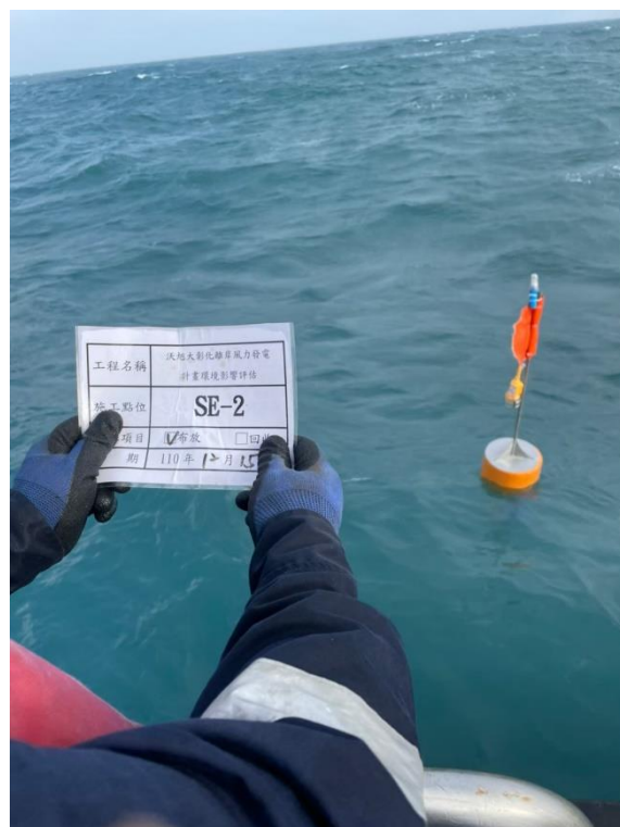
圖 2.6-3 水下噪音儀器 SE-2 現場佈放
