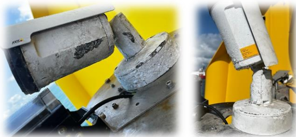
圖1.6-4 監測設備鏽蝕情況
