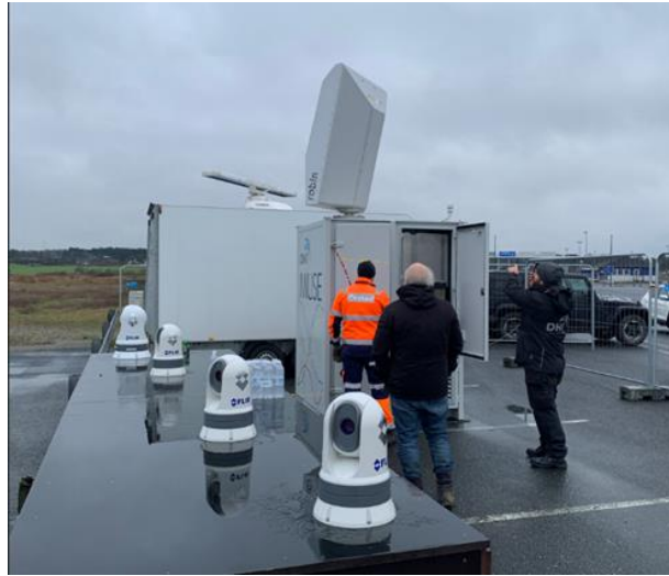
圖4.1-1 本計畫鳥類監測設備於丹麥進行FAT之示意照
